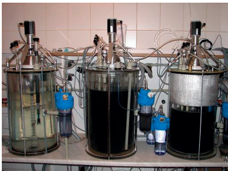
Rysunek 15. Stanowisko badawcze złożone z trzech reaktorów
