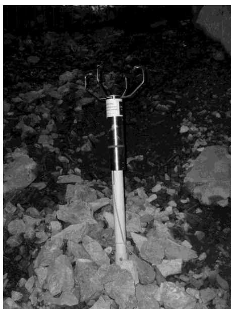
Ryc. 34. Anemometr akustyczny typu 2D umieszczony przy wyjściu z Demänovskiej JL (fot. K. Strug).
