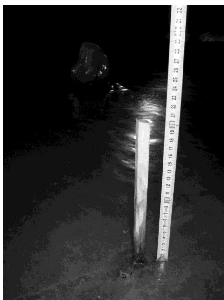
Ryc. 26. Pomiar wysokości drewnianej tyczki zainstalowanej w monolicie lodowym w Dobšinskiej JL (fot. K. Strug).
