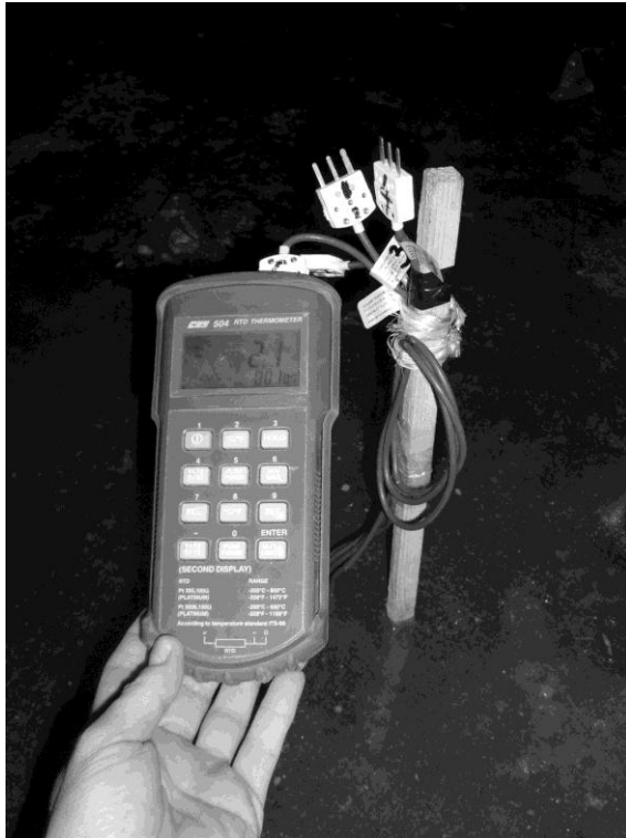
Ryc. 38. Pomiar temperatury monolitu lodowego przy użyciu multimetru typu CHY-504 w Dobšinskiej JL w profilu „A” (fot. K. Strug).
