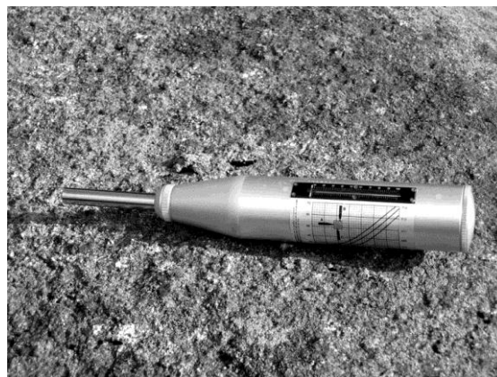
Ryc. 1. Młotek Schmidta typu N. (fot. P. Migoń, za zgodą autora)
