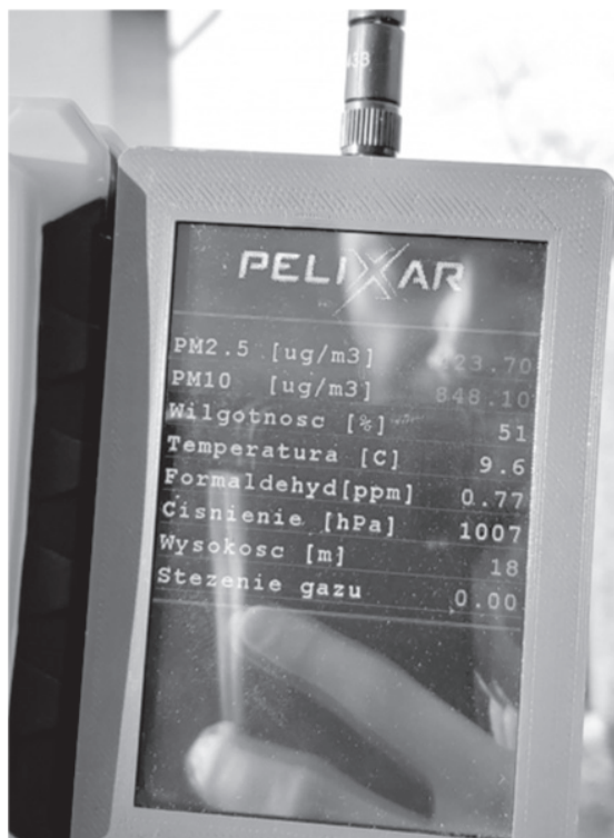
Fot. 2. Odczyt z monitora relacjonującego w czasie rzeczywistym wyniki przeprowadzanego badania jakości powietrza z użyciem bezzałogowego statku powietrznego
